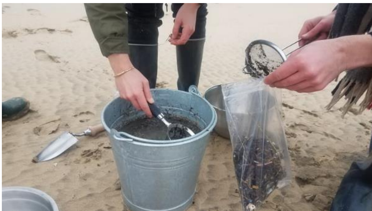
Figure 3 : Séparation de la fraction flottante (matières organiques et plastiques) du sédiment et stockage dans le contenant avant l'envoi au Cedre (source : Cedre)
